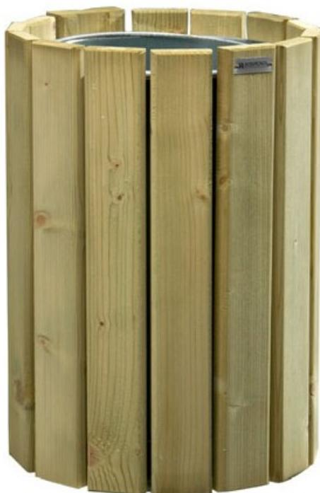
Corbeille murale classique. Structure en acier zingué bichromaté, ép. 4 mm. 14 lattes en bois résineux traité autoclave, épaisseur 20 mm. Bac intérieur avec anse en acier galvanisé avec verrouillage par système quart de tour, diamètre 26 X H 43 cm. Fixation murale en 2 points. Dims (cm) : diamètre 32 X H 45. Poids 7,3 kg. Volume 20L.
