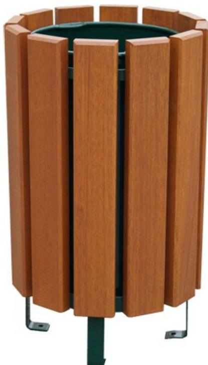
Corbeille fabriquée avec une structure acier, finition peinture au four coloris vert RAL 6005. Habillage par 12 lames de bois traité et vernis en bois exotique. Equipée d'un seau amovible. Socle de fond. Volume 80 L. Dims (cm) : diamètre 45 X H 83. Poids : 30 kg. A poser ou à sceller.
