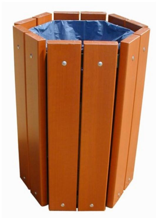
Fabriquée en France, stock permanent. Corbeille de propreté hexagonale, à sceller. Ses plus : pas d'angle vif pour plus de sécurité, livrée montée. Armature et porte sac en acier étiré 40 X 4 mm, finition peinture poudre, double couche 100 pour cent polyester cuite au four, coloris vert. Habillage avec 12 lattes de bois exotique de qualité supérieure, section 27 X 95 mm. Finition lasure acajou doré. Volume 50 L. Dims (cm) : diamètre 43 X H 60, pattes de scellement L30 cm. Poids : 18 kg.
