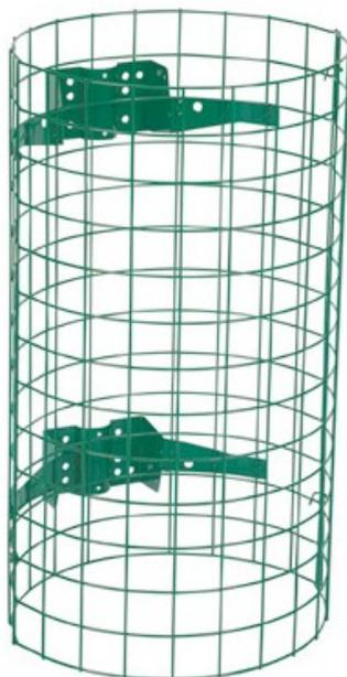
Grille de protection pour support de sac Nice. Grille et fixation en acier galvanisé. Finition peinture poudre polyester, coloris vert. Crochets de fermeture. Plaque de fixation pour fixation murale ou sur poteau. Dims (cm) : diamètre 47 X H 78. Poids 5,3 kg.
