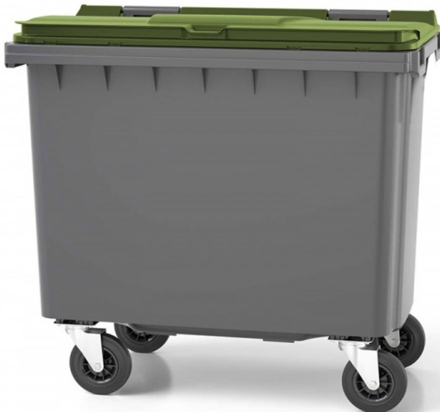
Bac roulant 660 L fabriqué en PEHD injecté. Norme EN 840. Préhension frontale. Equipé de 4 roues diamètre 160 mm avec bandage caoutchouc. Corps gris. Coloris de couvercle au choix : rouge, vert, gris anthracite, bleu, jaune, marron. Dims (cm) : 126,8 x 79,7 x H120,2. Poids : 38 kg.
