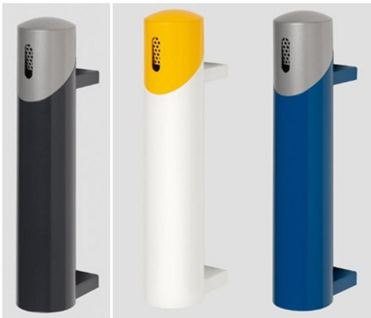
Fabriqué en tôle d'acier galvanisé, finition peinture époxy anti-UV haute qualité. 3 coloris au choix : corps blanc RAL 9016 , tête jaune (RAL 1023), corps bleu RAL 5010 , tête argent, corps anthracite RAL 7021 tête argent. Cendrier avec tête amovible sécurisée avec une clé, seau intérieur amovible pour un vidage facile. Volume 1,4 L. Dims (cm) : H 51 X P 17 X L 10. Poids : 5,3 kg.
