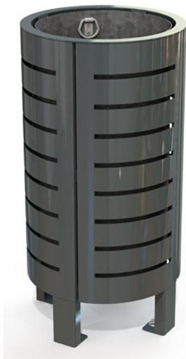
Corbeille moderne avec une belle finition. Structure en tôle d'acier électrozingué ép. 3 mm. Habillage en tôle d'acier ép. 2 mm découpée au laser. Finition thermolaquée, coloris au choix selon RAL. Bac intérieur en tôle d'acier galvanisé. Fixation au sol sur sol béton par chevillage. Volume 40 L. Dims (cm) : diamètre 36,5 x H71,9. Poids : 23 kg.
