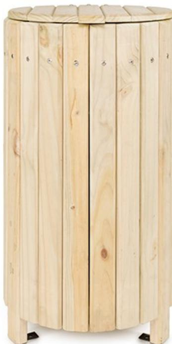
Corbeille ronde en pin traité autoclave classe 4. Support sac intérieur en acier. Couvercle semi-pliable pour un changement facile du sac et pour protéger l'intérieur. Visserie en inox. Fixation au sol par 3 vis M8 (non fournies). Volume : 90 L. Dims (cm) : L 52 X P 48 X H 91.
