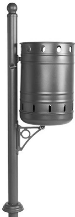
Cuve en acier galvanisé embouti. Poteau de fixation en acier galvanisé de 60 mm de diamètre. Cuve basculante à verrouillage automatique et ouverture par clé triangulaire standard. Couche primaire époxy et thermolaquage poudre polyester coloris noir forge. Pose aisée par scellement au sol du poteau de fixation de la corbeille. Avec enjoliveur de poteau au sol. Dims (cm) : L32 x P40 x H46/146,5.
