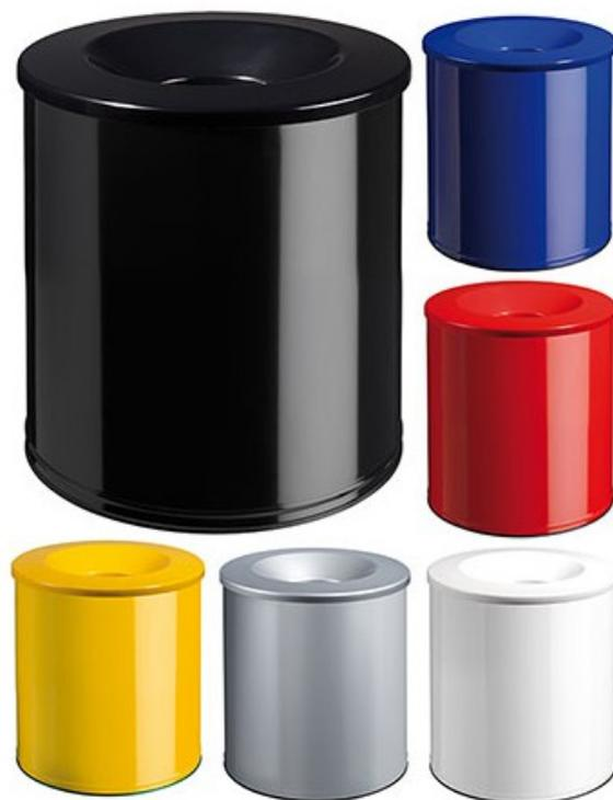
Corbeille anti-feu avec homologation du Centre National de Prévention et de Protection. Conformes aux normes de sécurité. Tête étouffoir en acier poudré époxy (ép. 1 mm). Elles empêchent la combustion des déchets et évitent la propagation du feu. Ouverture diamètre 11,5 cm. Corps en acier poudré époxy (ép. 0,5 mm). 6 coloris au choix : blanc, noir, bleu, rouge, gris, jaune. Profilé caoutchouc antidérapant fixé sur la base de la corbeille. Volume 15L
